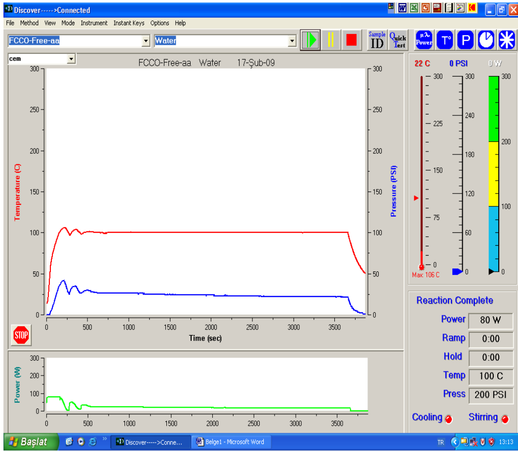
Şekil 2.1. Bir mikrodalga reaksiyonun bilgisayar üzerinden takibi
