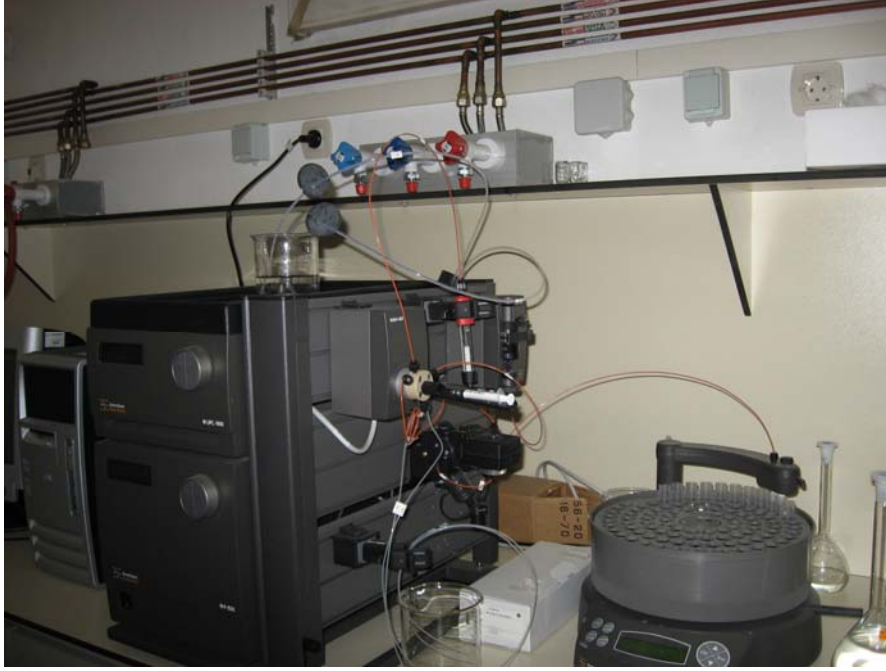
Şekil 3.25. Deneylede kullanılan HIBS dolgulu kolon ve FPLC sistemi
