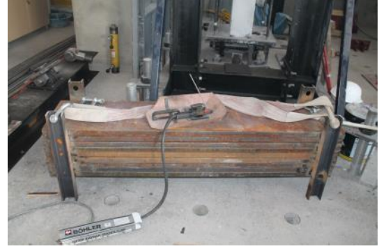
Görsel 3.20. İki parça olarak toplam 2,3 ton eksenel yük
