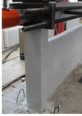
(a) Kolondaki ilk eğilme çatlağı
