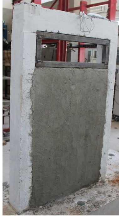
Görsel 4.52. Boşluğa eklenen metal pencere kasası
