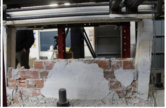
(d) Son çevrimdeki duvar hasarı
