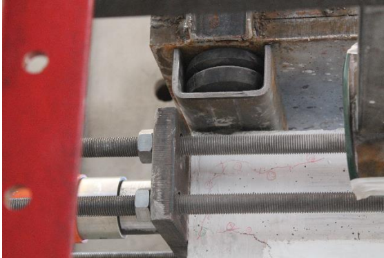
(a) Kirişteki ilk eğilme çatlağı
