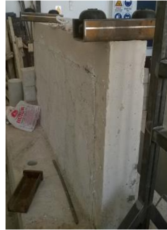
Görsel 3.21. Eksenel yükün yerleştirildiği elastomer takozlar
