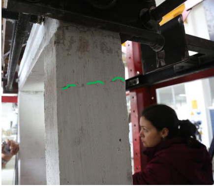
(a) Kolondaki ilk eğilme çatlađı
