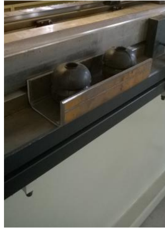
Görsel 3.21. Eksenel yükün yerleştirildiği elastomer takozlar
