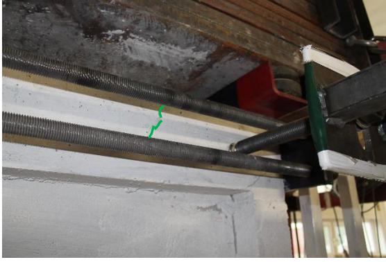
(a) Kirişteki ilk eğilme çatlağı
