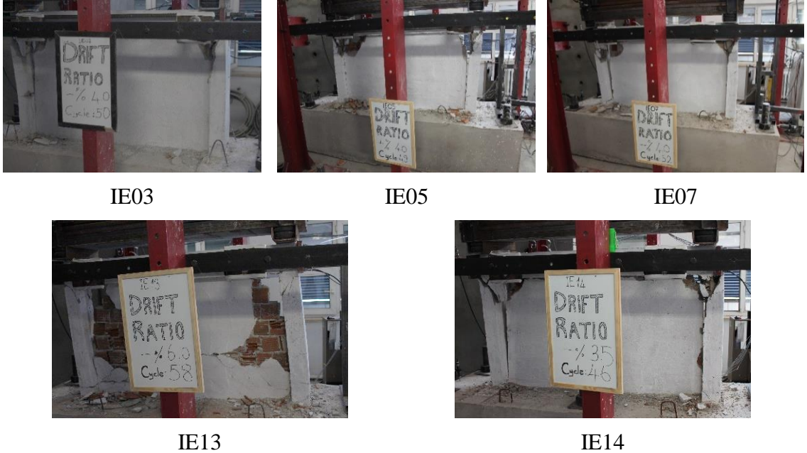
Görsel 7.1. Tam dolu dolgu duvarlı fakat kesme hasarı gözlemlenen numuneler
