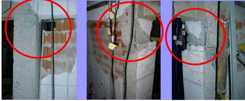
Görsel 2.7. Sürekli donatılı numunede dolgu duvar hasarı sonrası kolondaki kesme hasarı
