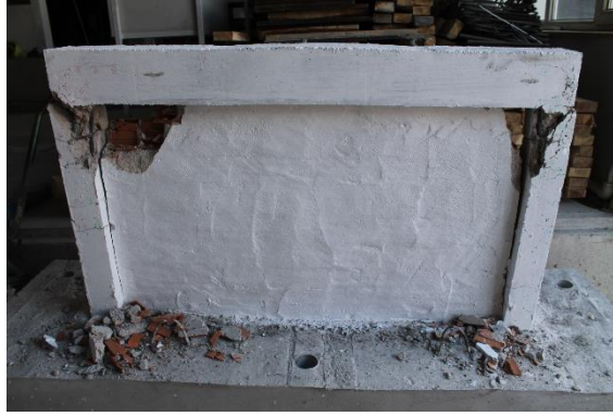
(c) Son çevrimdeki duvar hasarı
