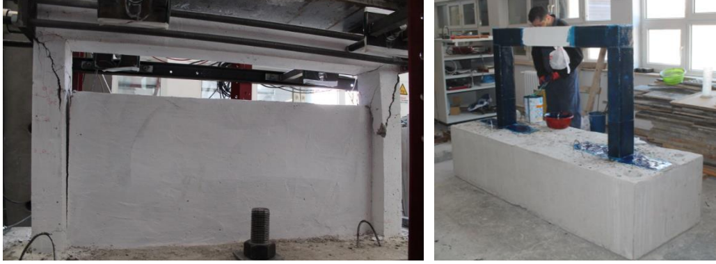
Görsel 3.18. Onarım öncesi kısa kolon hasarı görmüş numune ve onarılmış numune (IE02 ve IE02_G)
