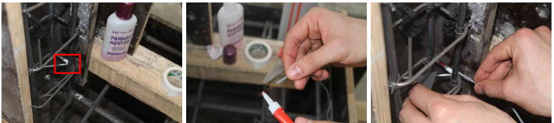
Görsel 3.11. Birim deformasyon ölçerin yapıştırılması
