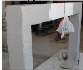
(e) Kimyasal bazlı tamir harcı uygulaması
