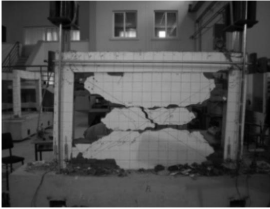
(a) Standart tuğla ile gözlenen hasar
