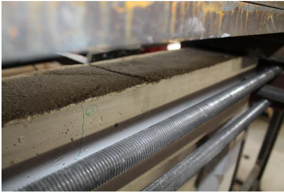
(a) Kirişteki ilk eğilme çatlağı
