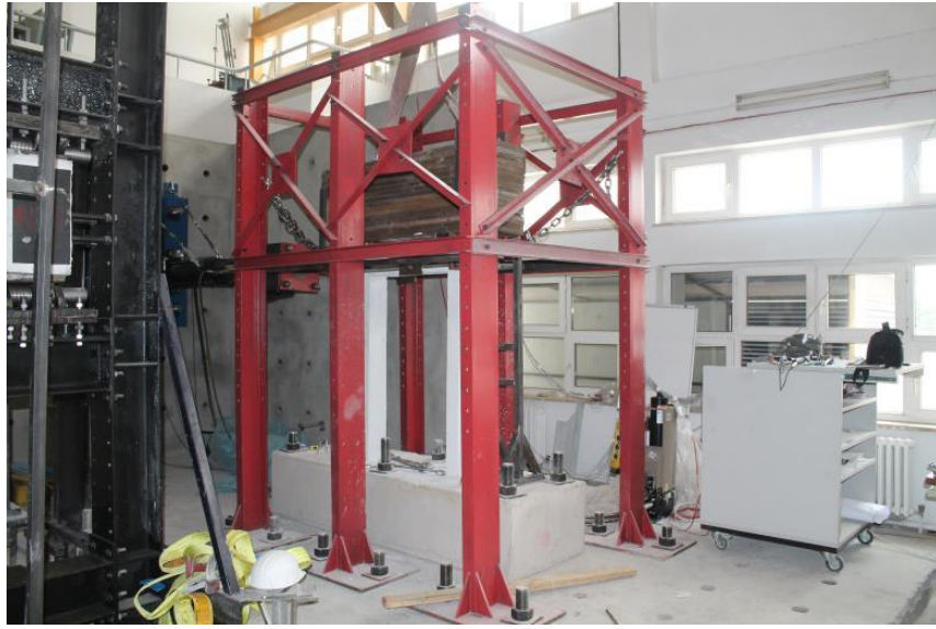
Görsel 3.19. Düzlem dışı hareketi önleme ve eksenel yük koruma çelik çerçevesi
