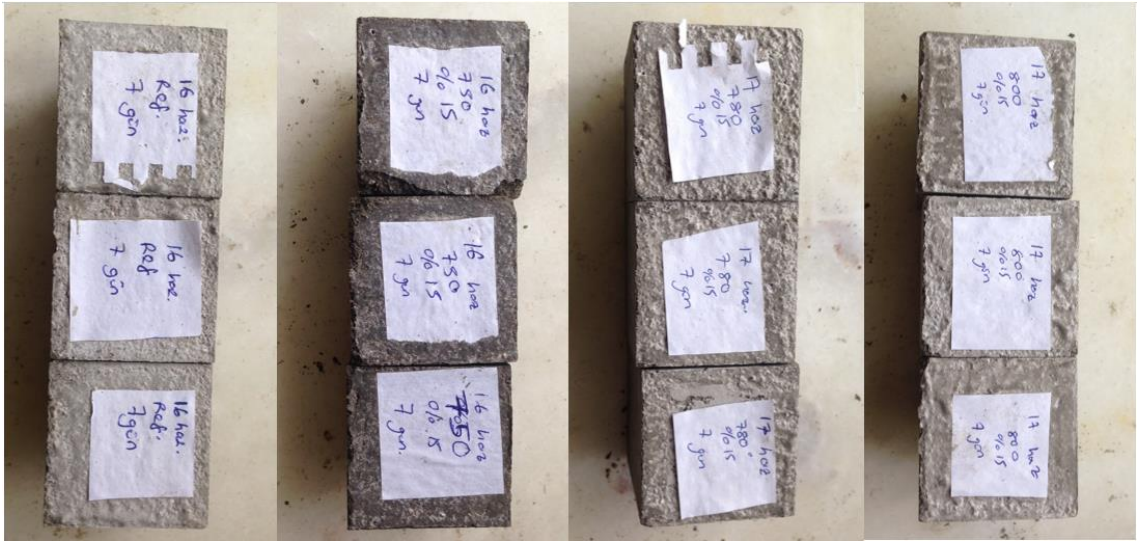
Görsel 3. 3. Referans ve %15-AS-1d harç numuneleri (soldan sağa: Referans, %15-750-AS-1d, %15-780-AS-1d ve %15-800-AS-1d)
