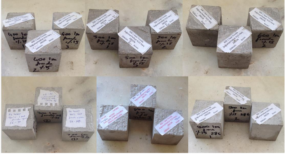
Görsel 3. 1. %15-FS-1s Harç numuneleri (üst sıra soldan sağa: %15-400-FS-1s, %15-500-FS-1s ve %15-600-FS-1s; alt sıra soldan sağa: %15-700-FS-1s, %15-800-FS-1s ve %15-900-FS-1s)
