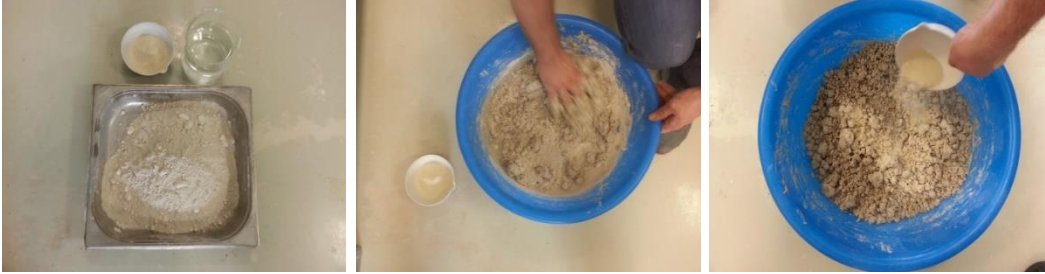
Şekil 3.9. Atık kil/bentonit karışımlarının hazırlanması
