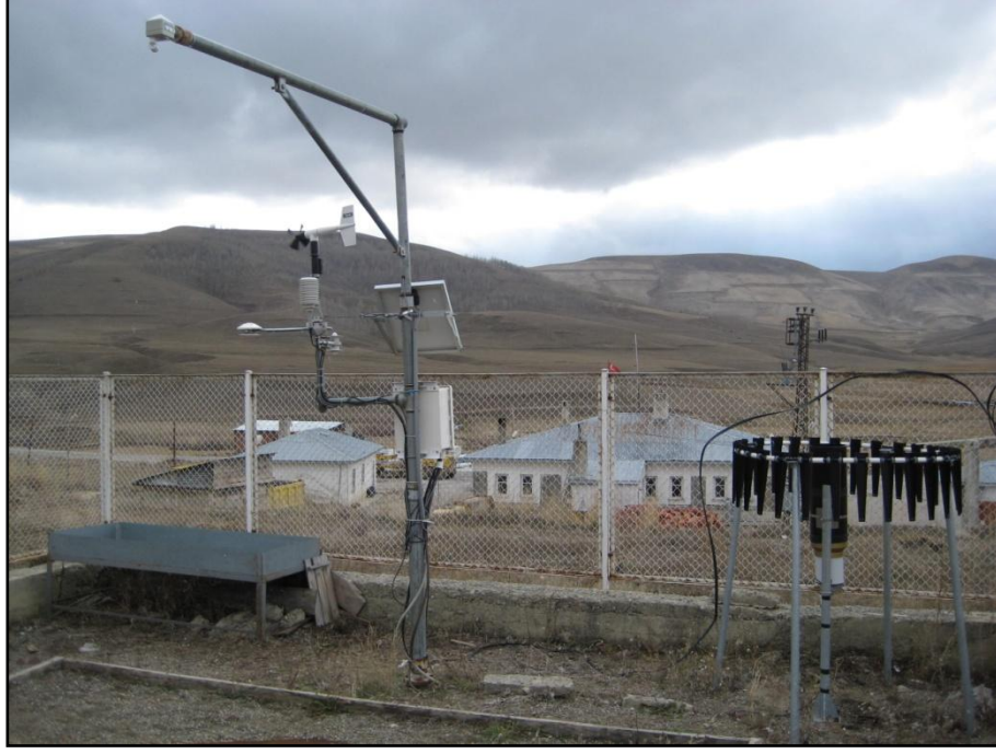
Şekil 2.11 Ovacık meteoroloji gözlem istasyonu yağış ölçer
