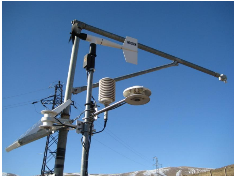
Şekil 2.9 Ovacık istasyonu radyasyon ve hava sıcaklığı ölçümleri
