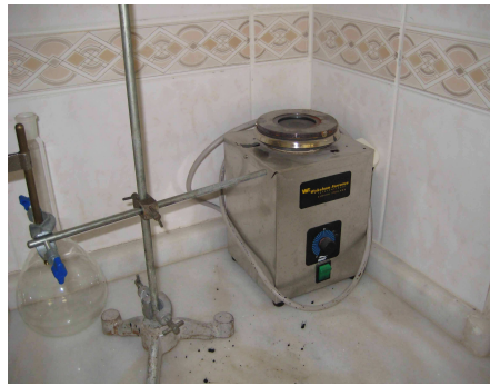
Şekil 6.9. Parlama ve yanma noktası tespiti için kullanılan deney aleti
