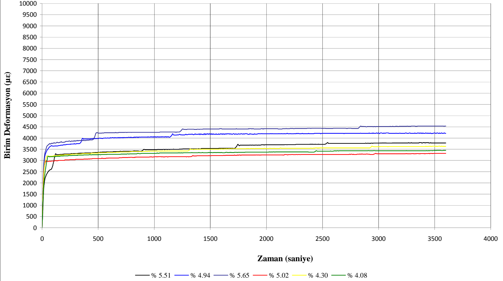
Şekil 6.47. % 4.0 PP katkılı numunelerin birim deformasyon-zaman grafikleri
