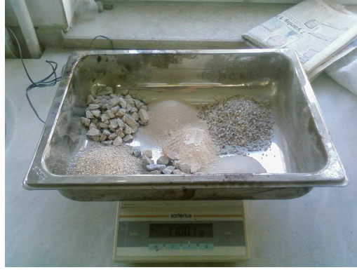
Şekil 6.14. Aşınma tabakası Tip-2 gradasyonuna göre elenmiş agrega
