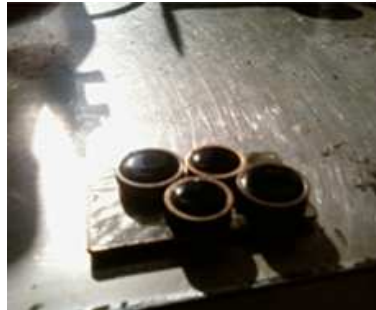
Şekil 6.8. Yumuşama noktası deney numuneleri
