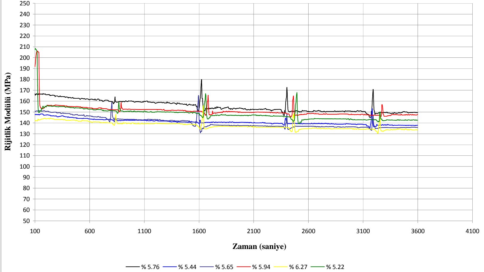
Şekil 6.79. % 4.5 PP katkılı numunelerin rijitlik modülü-zaman grafikleri
