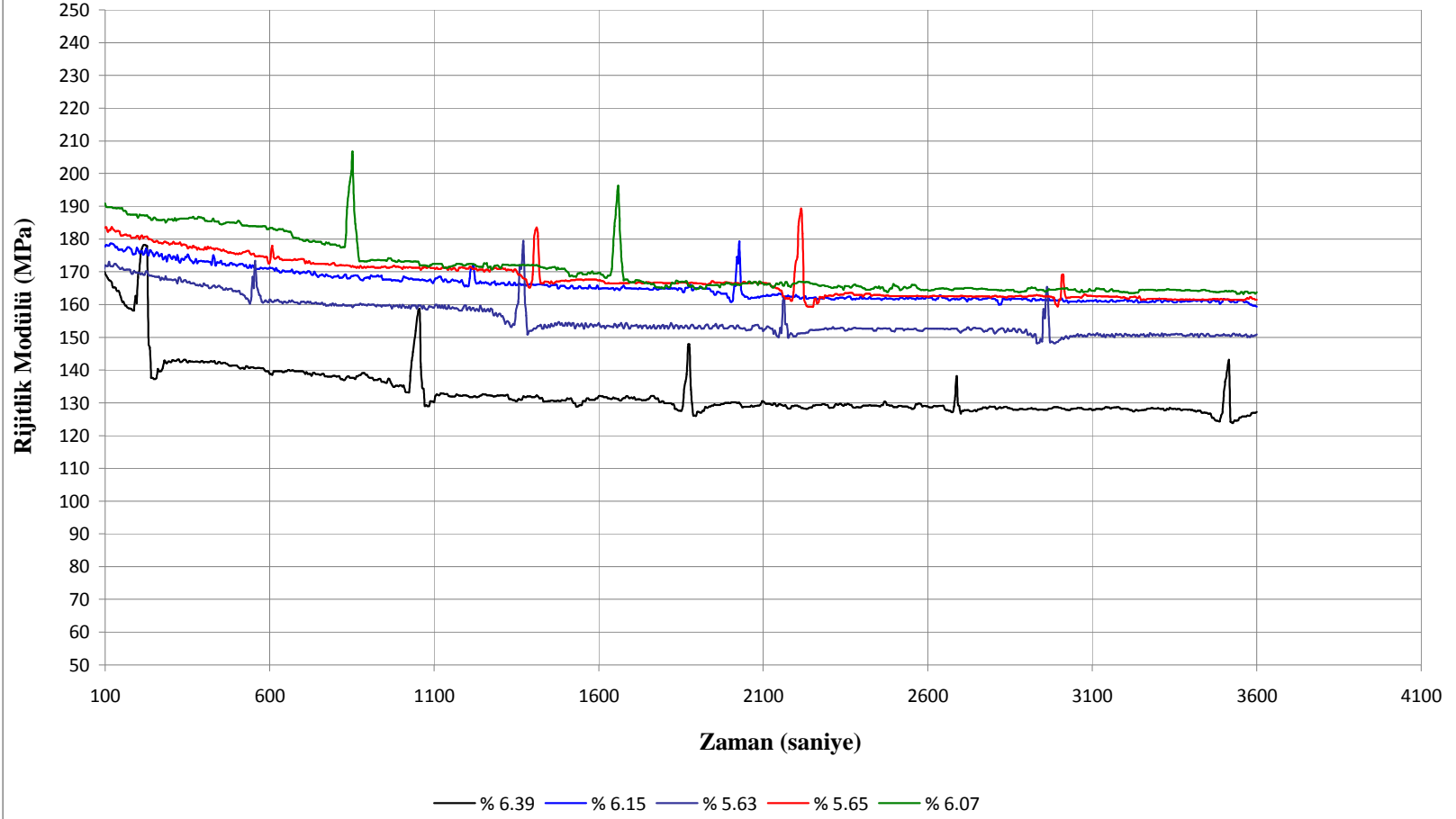
Şekil 6.80. % 5.0 PP katkılı numunelerin rijitlik modülü-zaman grafikleri
