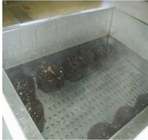
Şekil 6.17. Su banyosunda bekletilen Marshall numuneleri
