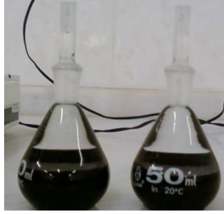
Şekil 6.13. Bitüm ve saf su ile doldurulmuş piknometreler
