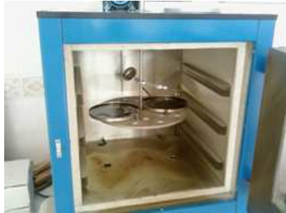
Şekil 6.11. İnce film halinde ısıtma kaybı deney aleti ve deney numuneleri
