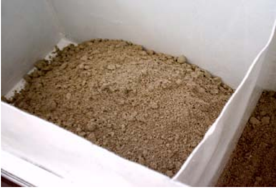
Şekil 5.12. Geçirimsizlik malzemesinin sıkıştırılmamış hali
