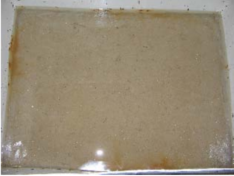
Şekil 6.34. Gözlem süresi sonunda distile su çözeltisi bulunan bölmenin görüntüsü
