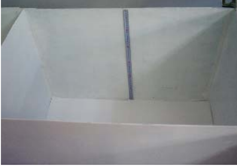
Şekil 5.11. İki kat poroz kağıt yerleştirilen deponi bölmeleri
