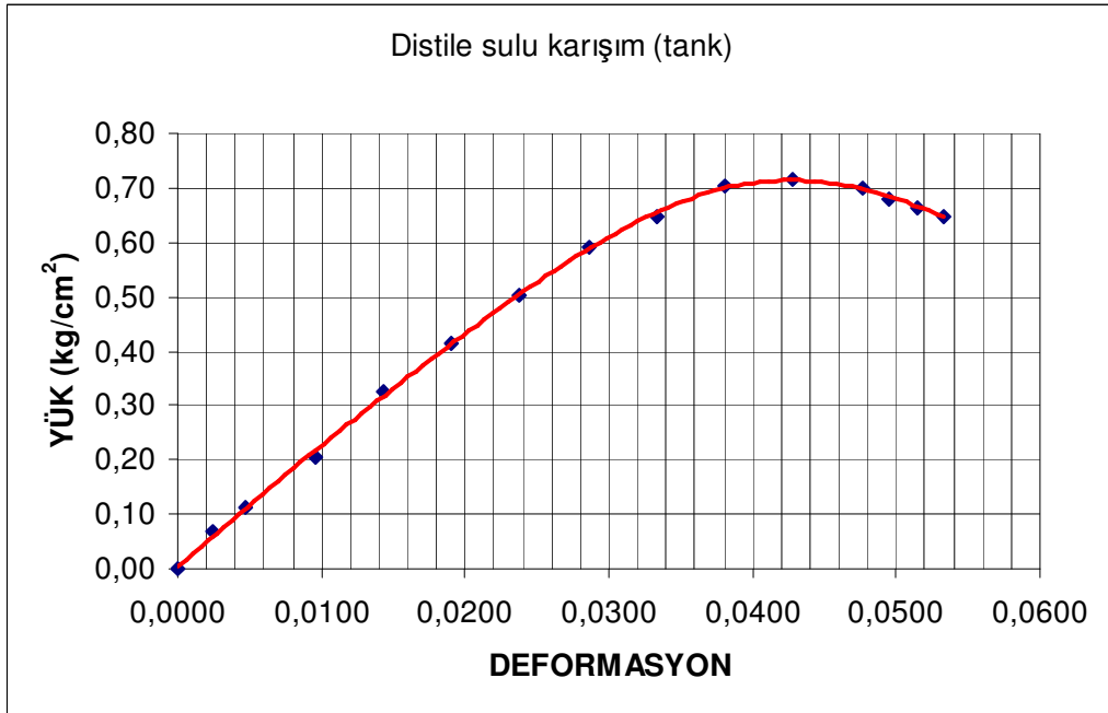
Şekil 6.18. Distile sulu karışımın (tank)16 haftalık kür serbest basınç grafiği (3) (W= 773 gr H= 10,5 cm D= 7,4 cm q_u = 0,72 \text{ kg/cm}^2 = 71 \text{ kPa} )
