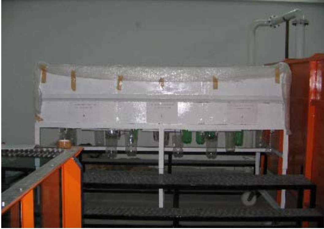
Şekil 5.20. Minyatür deponinin naylon branda ile kaplanması
