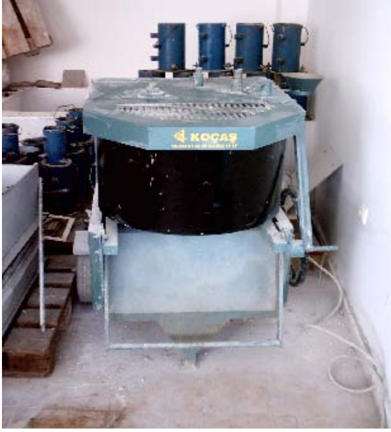
Şekil 5.8. Geçirimsizlik malzemelerinin karıştırıldığı mikser
