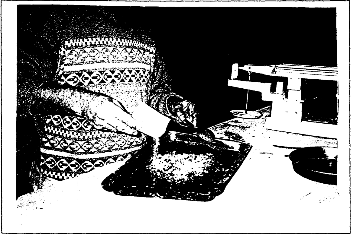
Şekil 6.7. Islak Agregat Karışımına Kireç İlavesi
