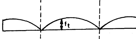
d) Beton çekme gerilmesi dağılımı
