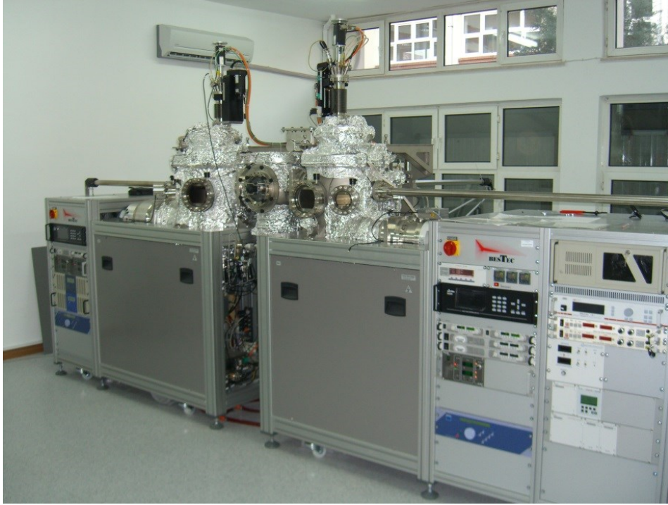
Şekil 6.2. Anadolu Üniversitesi İleri Teknoloji İnce Film Laboratuvarı'nda bulunan sıçratma sistemi
