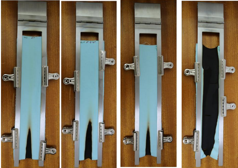
Şekil 8.3 a- U4, b- U8, c- U5 ve U9' un Dikey yanma testi sonucu
