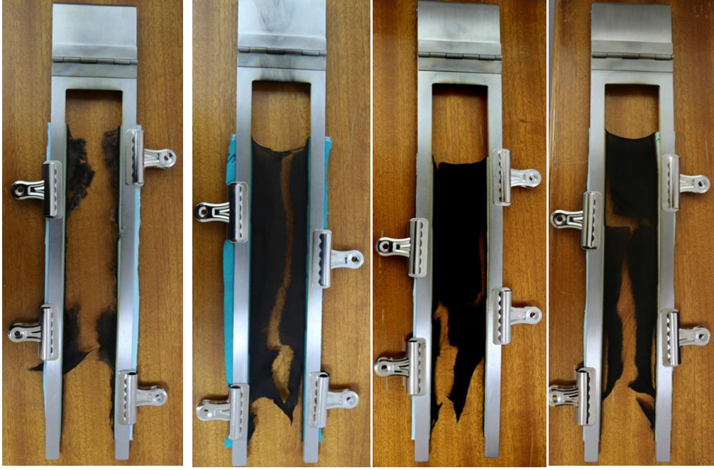
Şekil 8.2 a-Referans kumaş, b-U1, c-U2, d-U3'ün Dikey yanma testi sonuçları
