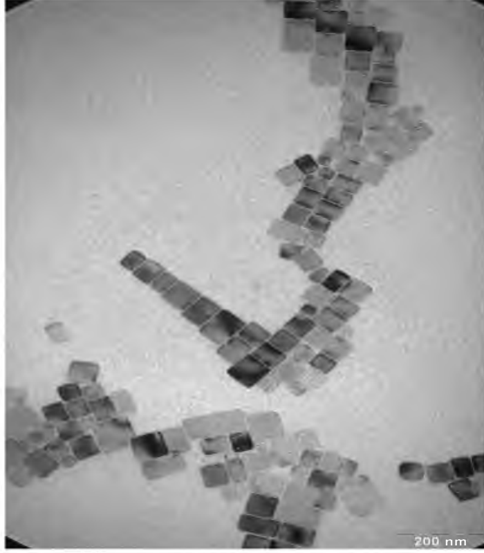
Şekil 3.7. L4 Formülasyonu (Lipozom+FITC) TEM görüntüsü (87000X büyütme)
