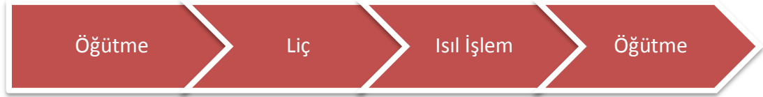
Şekil 2.1.1. Hekzagonal Bor Nitrür Üretimi Akım Şeması
