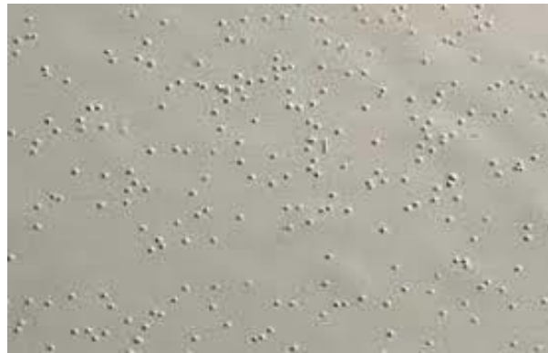
Şekil 2.18. Yüzeye uygulanmış boyada oluşan tepeler ve çukurluklar [53].
