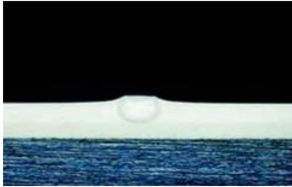
Şekil 2.13. Pinhol kusuru kesit görüntüsü [53].
