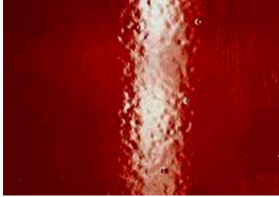
Şekil 2.14. Boyada portakal kabuğu görüntüsü [17].
