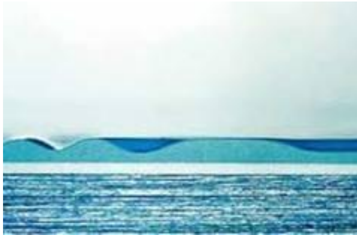
Şekil 2.9. Yüzeye uygulanmış boyada kabarma kusurunun kesit görüntüsü [53].
