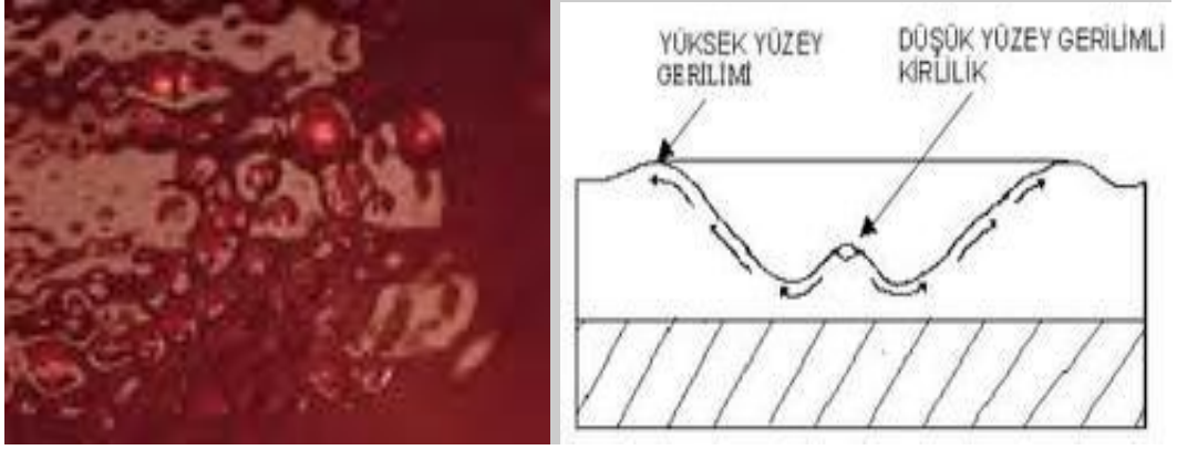
Şekil 2.10. Boya yüzeyinde krater oluşumu görüntüsü (a) Krater oluşumunun şematik gösterimi (b) [17]
