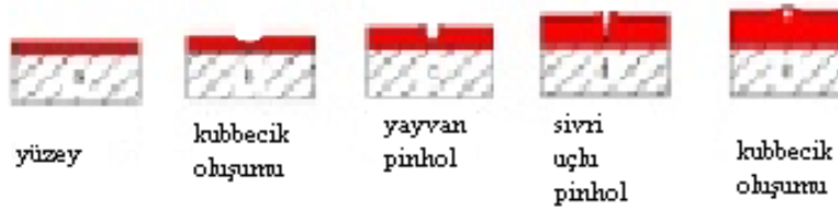
Şekil 2.12. Boya yüzeyinde pinhol oluşumu [53].
