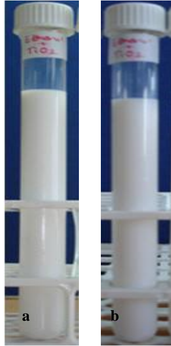
Şekil 5.4. Alkol ortamında disperse edilmiş TS toz başlangıç hali (a) 7 gün sonra (b)
