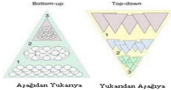
Şekil 3.1. Nanoteknolojik üretim teknikleri buttom up teknolojisi şematik gösterimi (a) top down teknolojisi şematik gösterimi (b)
