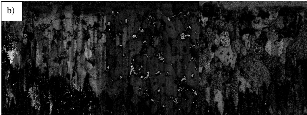
Şekil 4.45 a) sıvı faz içeren ve b) sıvı faz içermeyen numuneye ait kalite patern haritaları (Not: Üç farklı görüntü birleştirilmiştir)
