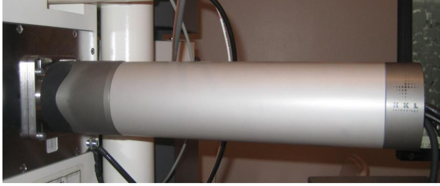
Şekil 3.5 Oxford Inca HKL EBSD dedektörüne ait görüntü
