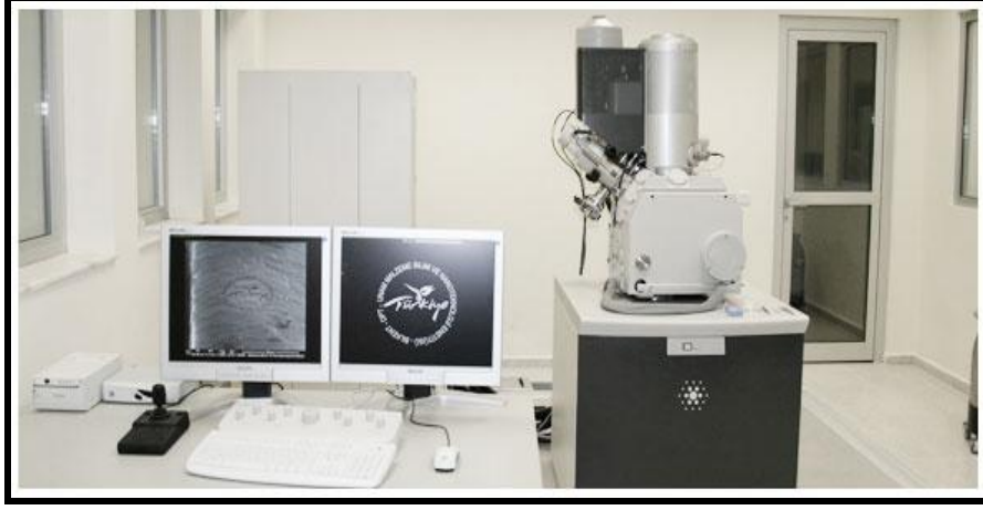
Şekil 4.3. FIB cihazına ait genel görüntü
