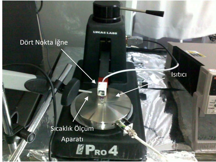
Resim 3.4. FPP sistemi, sisteme entegre edilen ısıtıcı ve filmin yüzeyindeki sıcaklığı ölçmek için kullanılan sıcaklık ölçüm aparatı
