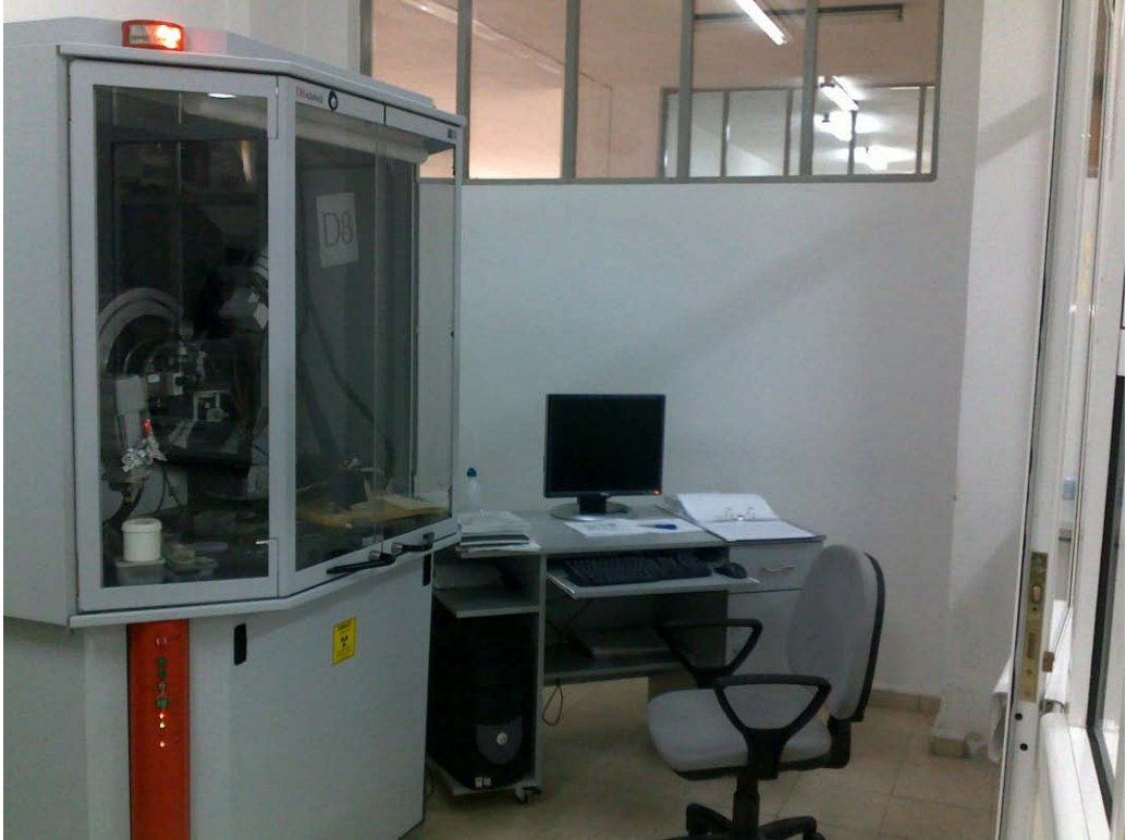
Resim 3.2. Bruker D8 Advance marka X-ışını ölçüm cihazı.
