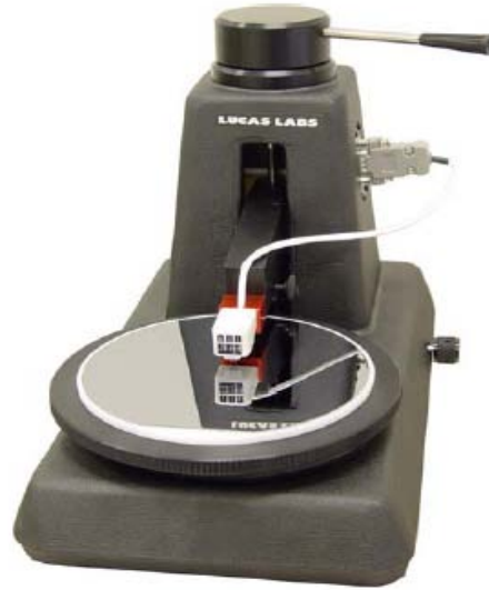
Resim 3.3. VO_x ince filmlerin elektriksel özelliklerinin belirlenmesinde kullanılan FPP sistemi.
