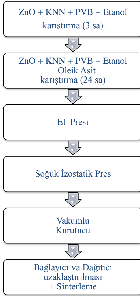
Şekil 3.2 Molce % 2 ZnO katkılı KNN üretim prosedürü
