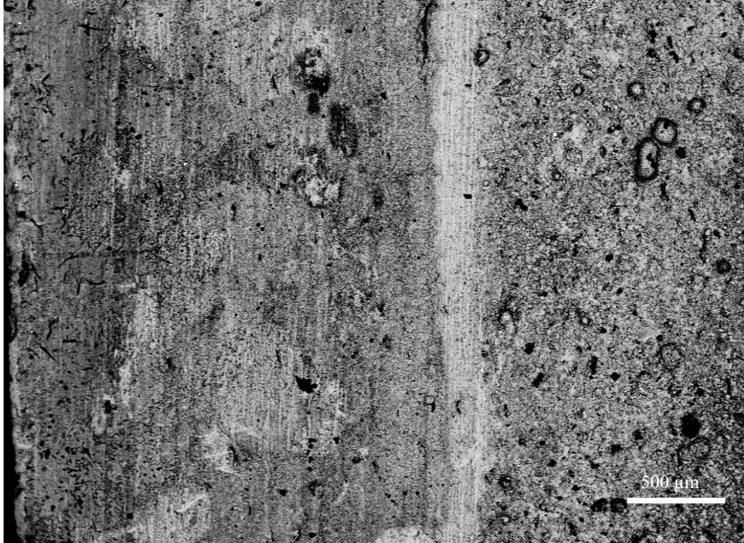
Şekil 4.8 Pt işaretleyicili difüzyon çiftinin SEM geri yansıyan elektron görüntüsü
