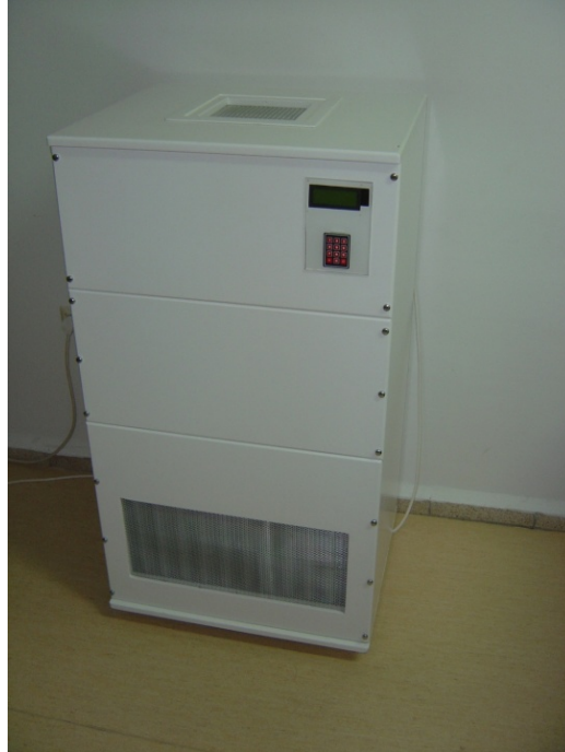
Şekil 4.16. Hava sterilizasyon ünitesi.
