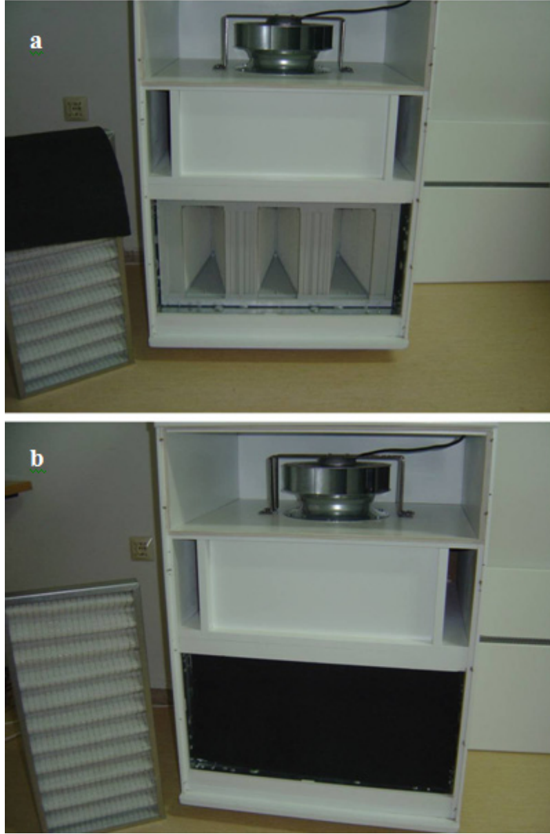
Şekil 4.14. Filtre ekipmanlarından (a) V filtre (b) karbon filtre montajı.
