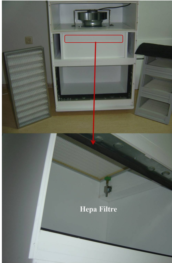
Şekil 4.13. Filtre ekipmanlarından hepa filtre montajı.
