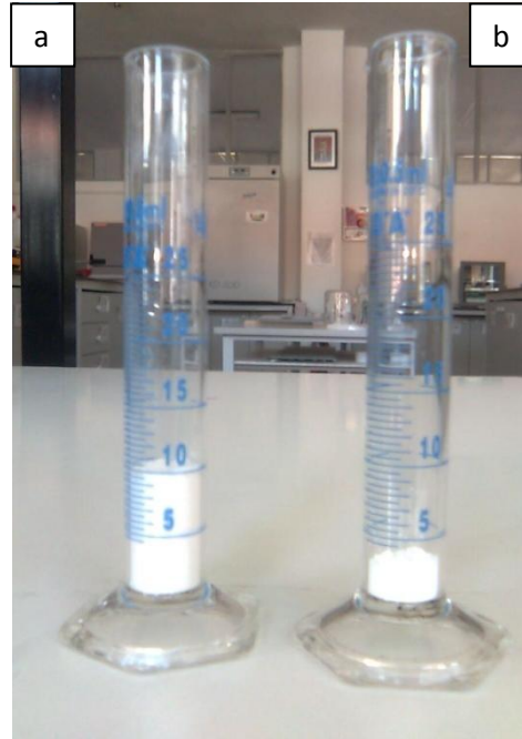
Şekil 8.26. Aynı ağırlığa sahip 2 tozun paketleme yoğunluğu ölçümü görüntüsü (a) sentezlenen plaka şekilli tozlar (b) ticari ZnO (merck)
