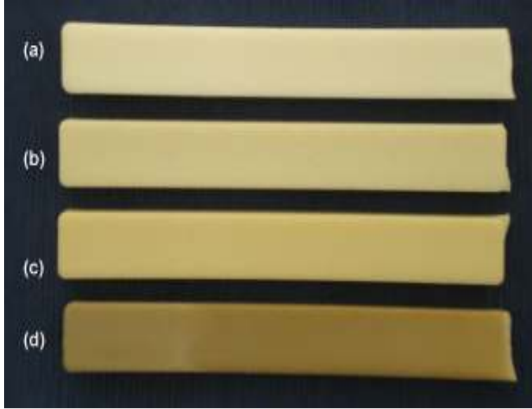
Şekil 9.12. (a) Katkısız PBT; %3 PEG ile öğütülmüş ZAG 1455 tozun PBT içerisine (b) %0.5, (c) %1, (d) %3 oranında eklenmesiyle hazırlanan numuneler
