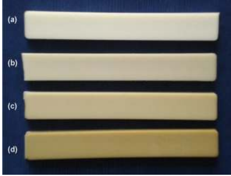
Şekil 9.11. (a) Katkısız PBT; %1 PEG ile öğütülmüş ZAG 1455 tozun PBT içerisine (b) %0.5, (c) %1, (d) %3 oranında eklenmesiyle hazırlanan numuneler
