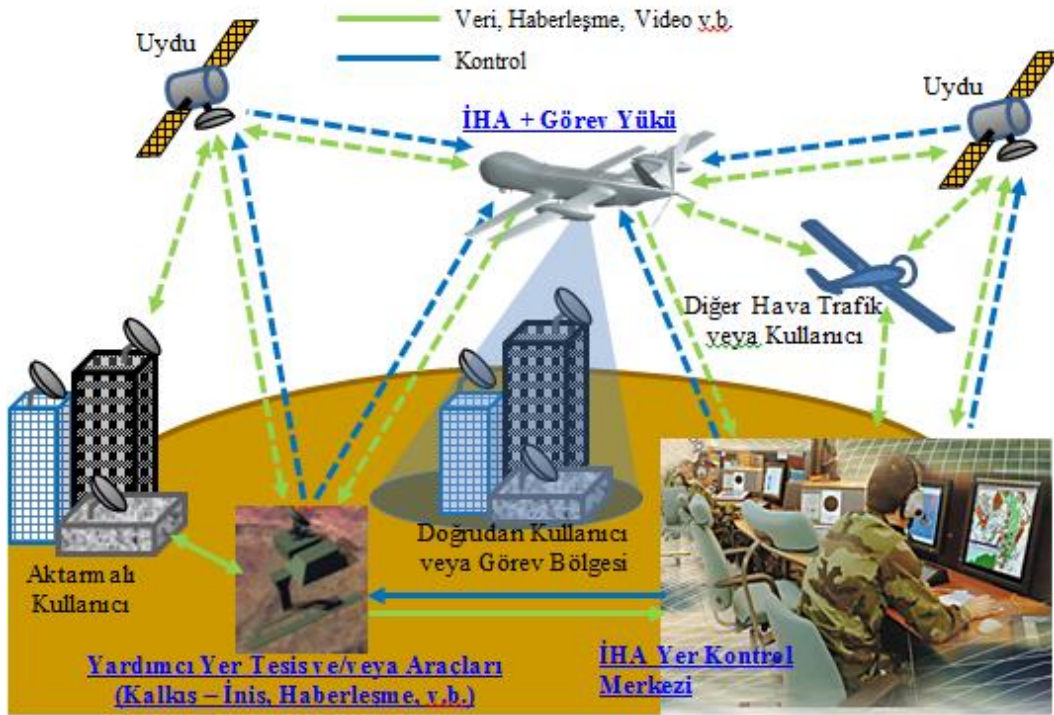
Şekil 1.3. Sivil hava sahalarını kapsayan İHAS görevlerinde örnek bir kontrol, haberleşme ve veri iletim ağı
