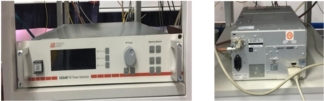
Görsel 4.4. Radyo frekans güç kaynağı ve eşleştirme ünitesi
