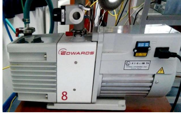
Görsel 4.2. Vakum pompası ve vakum ölçer
