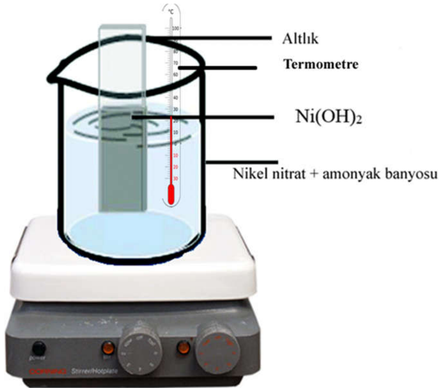
Şekil 4.1. CBD deney düzeneğinin şematik gösterimi
