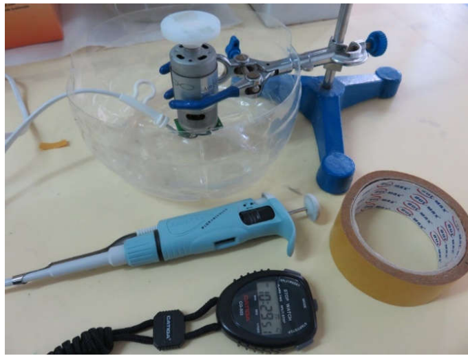
Şekil 4.38. Sol- jel döndürerek kaplama yöntemi için kullanılan deney düzeneği
