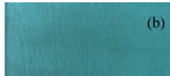
Şekil 4.31. (a) 1 SILAR döngüsüyle elde edilen NiO filminin yükseltgenme ve indirgenme durumlarına ait geçirgenlik spektrumları ve (b) yükseltgenme sonucu filmde oluşan kararmayı gösteren fotoğraf
