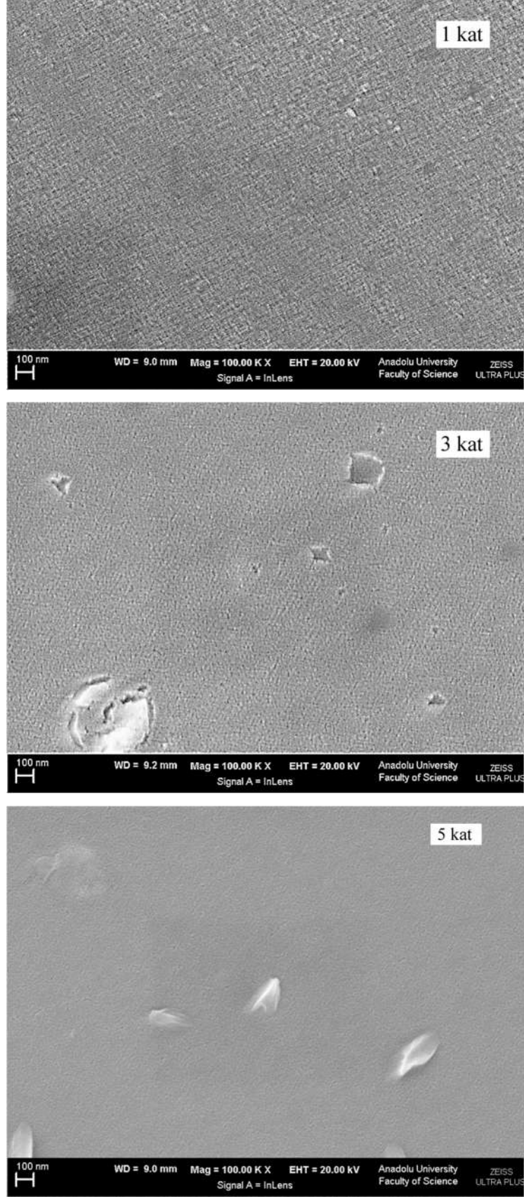
Şekil 4.42. Döndürerek kaplama yöntemiyle cam üzerine elde edilen NiO filmlerinin SEM görüntüleri
