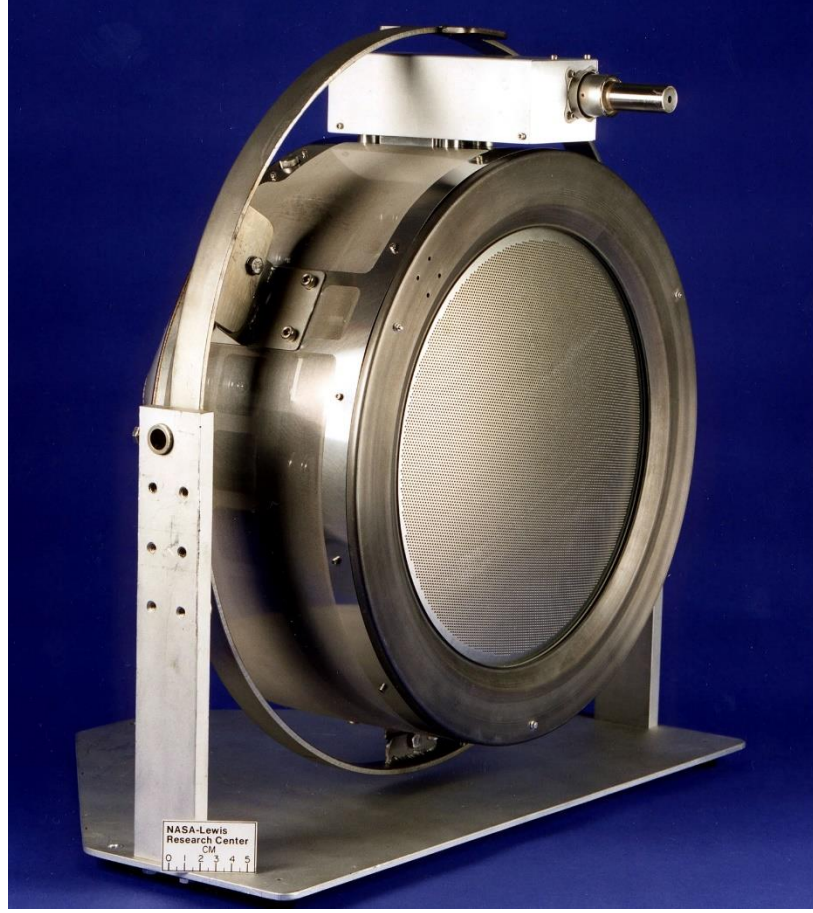
Görsel 6.1. NASA'nın geliştirdiği, NEXT (NASA Evolutionary Xenon Thruster) isimli iyon itici [75].
