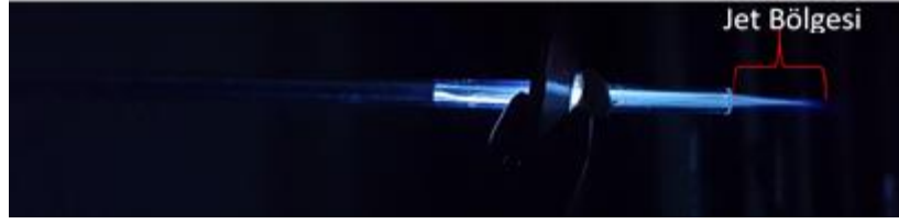
Görsel 7.4. Argon gazına ait oda sıcaklığında atmosferik basınç plazma.
