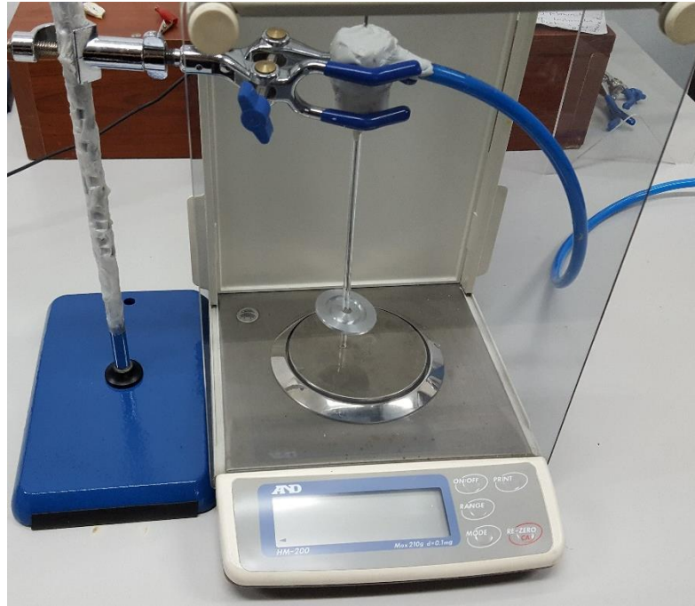
Görsel 7.1. İtki değerini deneysel olarak gözlemlemek için kurulan deney düzeneği.
