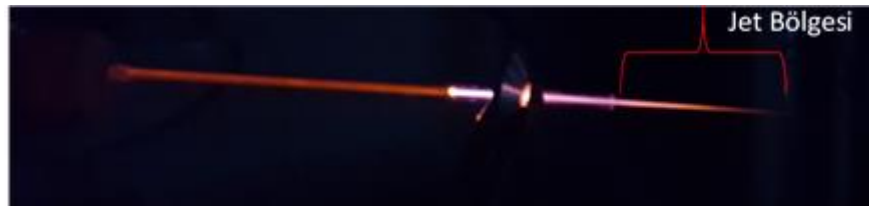
Görsel 7.3. Neon gazına ait oda sıcaklığında atmosferik basınç plazma.
