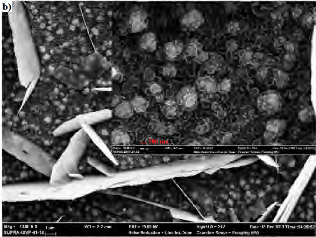
Şekil 4.73. ZnCl_2 kullanılarak ve depozisyon esnasında O_2 gazıyla doyurularak elde edilen çözeltiler ile (a) -0,99 V (b) -1,05 V değerlerindeki katodik potansiyellerde yapılan üretilere ait filmlerin 10000 ve 50000 büyütmedeki SEM görüntüleri
