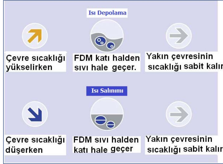
Şekil 4.2. Faz değiştiren malzemenin ısı depolaması ve ısı salınımı ( http://idak.gop.edu.tr/asari )
