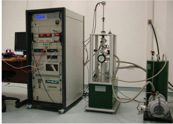
Şekil 3.8. ODTÜ Merkez Laboratuvarı'nda kurulu olan PPMS sistemi (Cryogenic Limited).
