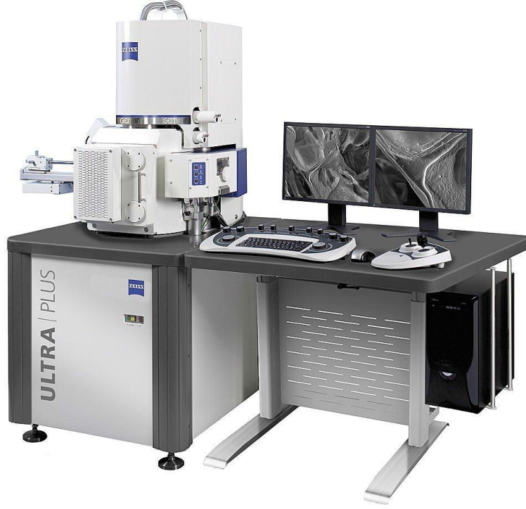
Şekil 5.1. Zeiss Ultraplus alan etkili taramalı elektron mikroskobu
