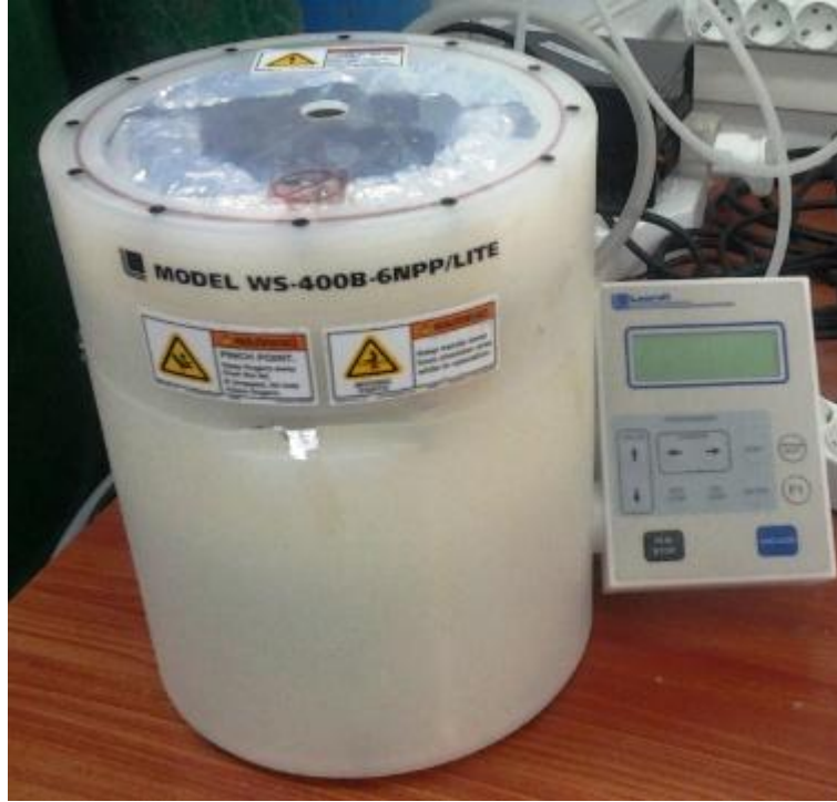
Şekil 3.7. Kullanılan spin kaplama cihazı
