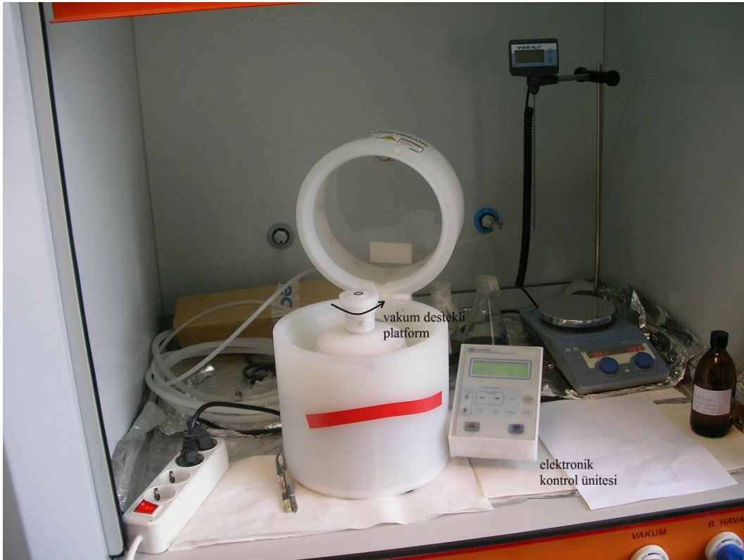
Şekil 3.2. Döndürerek kaplama cihazı (spin coater) görüntüsü.
