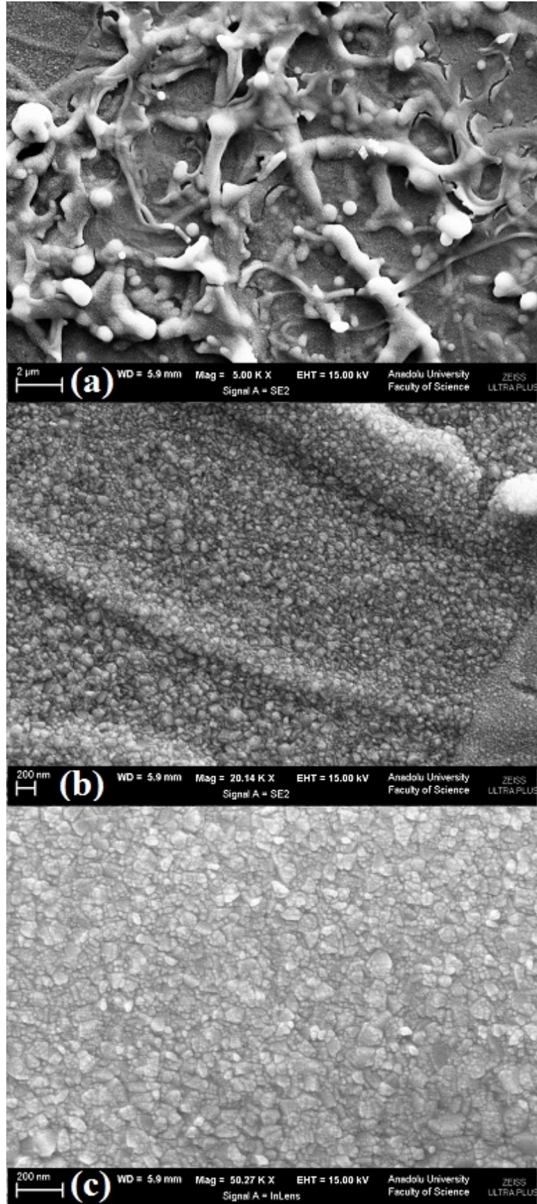
Şekil 5.4. 350 °C taban sıcaklığında elde edilen \text{SnO}_2 yarıiletken filminin farklı büyütme oranlarında alınan SEM görüntüleri
