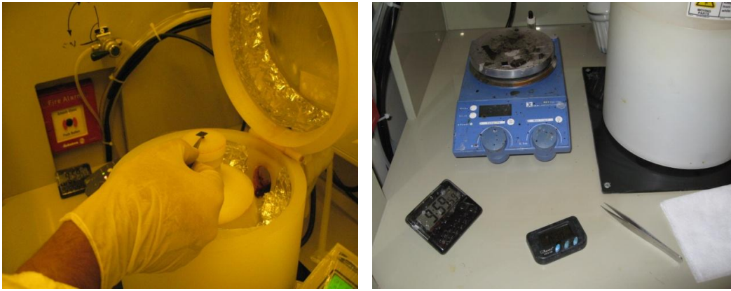
Şekil 5.8. Fotorezist kaplanan numuneye ısıtılma uygulama süreci
