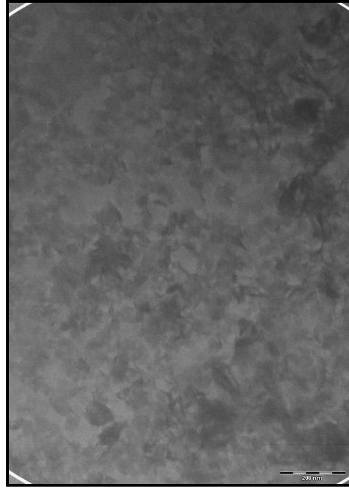
Şekil E2.2. Ni-CBA-Pd-Benzene konak-konuk bileşiğinin TEM görüntüsü
