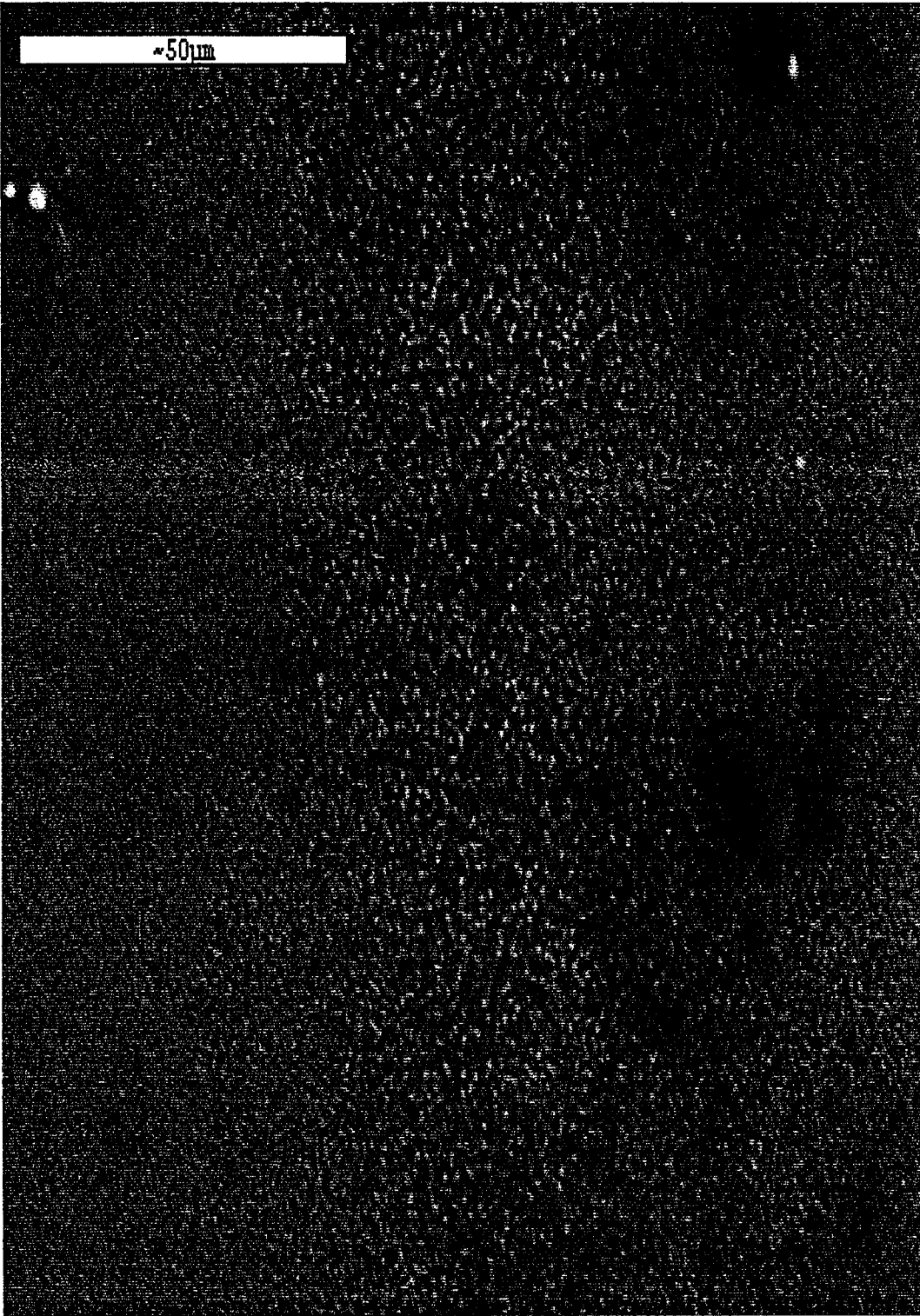
Şekil 5.9. 425\pm 5^{\circ}\text{C} taban sıcaklığında elde edilen merkezden en uzaktaki ZnS filminin 1820 büyütmedeki taramalı elektron mikroskobu görüntüsü
