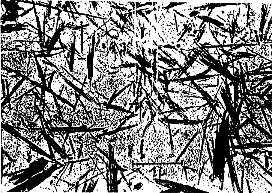
Şekil 3.1 Lületaşının Elektron Mikroskopuyla Çekilmiş Lifli Yapısı (3).
