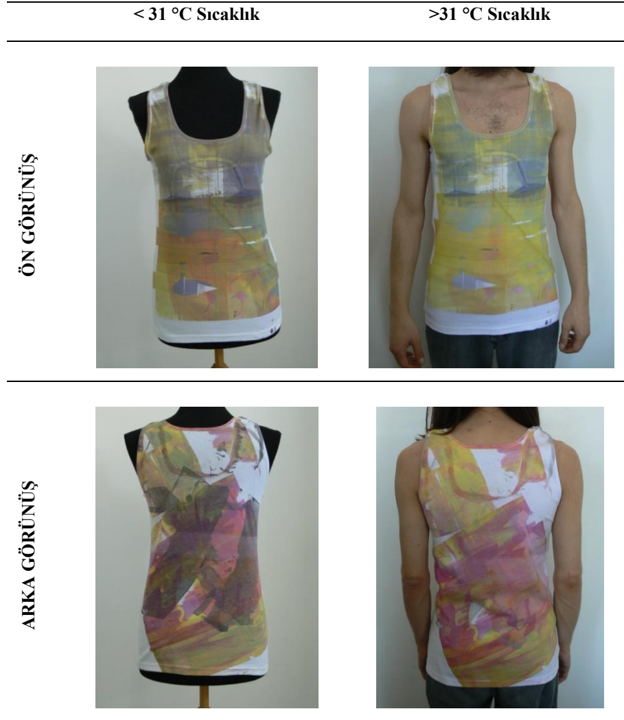
Görsel 5.4 Yuvarlak yaka % 100 pamuklu süprem atlet üzerine yapılan termokromik baskılarda gösterdiği renk değişimi
