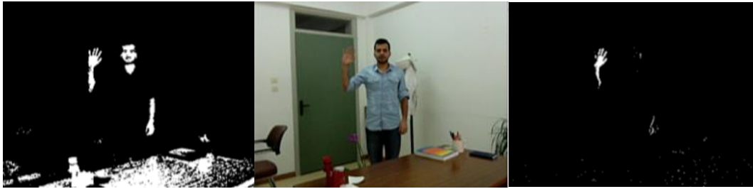
Şekil 4.9 Renk ile ayırma, orjinal görüntü ve hareket ile ayırma
