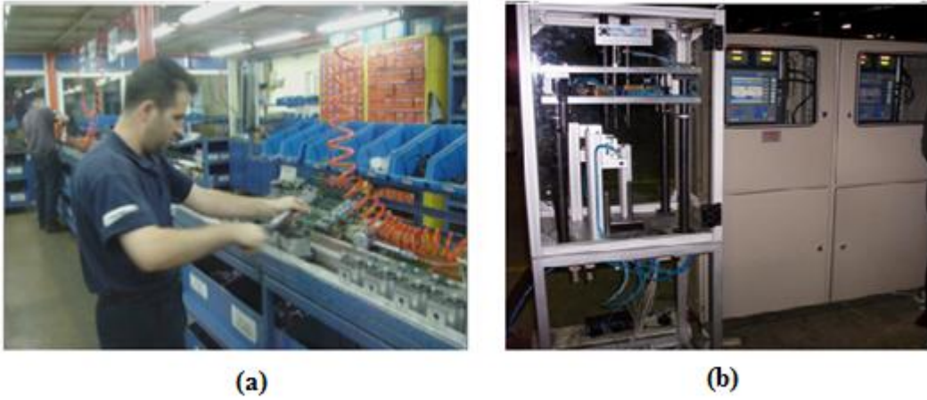
Şekil 4.14. Torklama operasyonu eski ve yeni durum (a) eski durumda torklama operasyonu (b) yeni durumda kullanılacak torklama ünitesi
