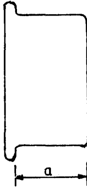
Şekil-5. Kenar şekil verilmiş kasağın yandan görünüşü
