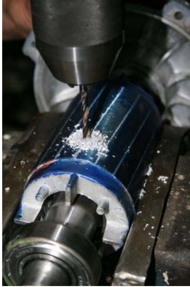
Şekil 5.3. Rotor çubukları üzerinde matkap ile delik açılması (rotor çubuklarının kırılması) işlemi
