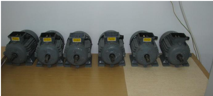
Şekil 5.1. Sentetik olarak çeşitli hataların oluşturulduğu asenkron motorlar
