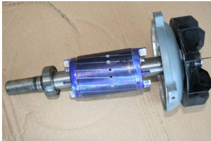
Şekil 5.4. Beş adet rotor çubuğu kırılmış bir rotor gövdesi
