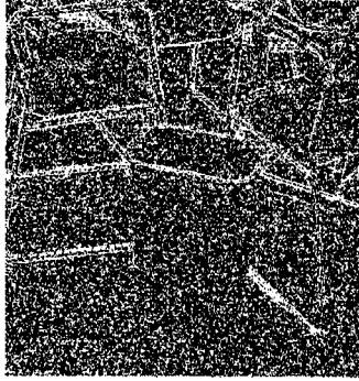
Şekil 4.6 (devamı): \sigma=30 için Gauss gürültü uygulanmış orijinal görüntü ve sırasıyla Sobel 3x3 ile con7sob5 sonuçları
