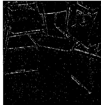
Şekil 4.6 (devamı): \sigma=40 için Gauss gürültü uygulanmış orijinal görüntü ve sırasıyla Sobel 3x3 ile con7sob5 sonuçları
