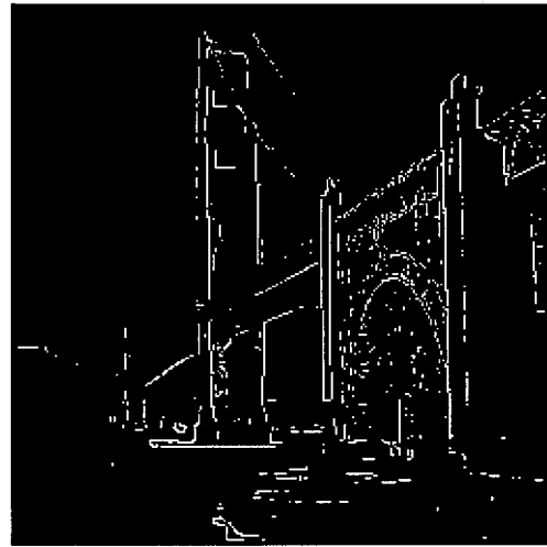
Şekil 2.1: Orijinal görüntü ve Roberts kenar algılayıcı uygulandığında elde edilen sonuç görüntüsü
