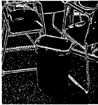
Şekil 4.6: \sigma=0 için Gauss gürültü uygulanmış orijinal görüntü ve sırasıyla Sobel 3x3 ile con7sob5 sonuçları
