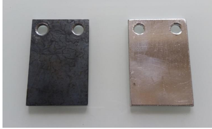
Şekil 5.2. Elektrot plakaları (Soldan sağa sırasıyla; Demir elektrot, Alüminyum elektrot)
