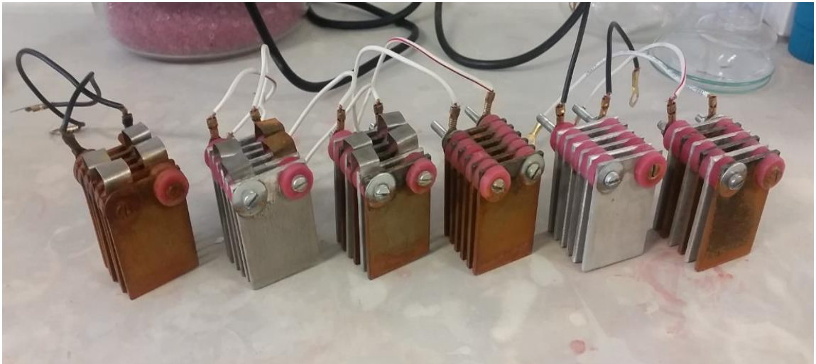
Şekil 5.3. Elektrot demetleri (Soldan sağa sırasıyla; M Fe-Fe, M Al-Al, M Al-Fe, B Fe-Fe, B Al-Al, B Al-Fe elektrot)
