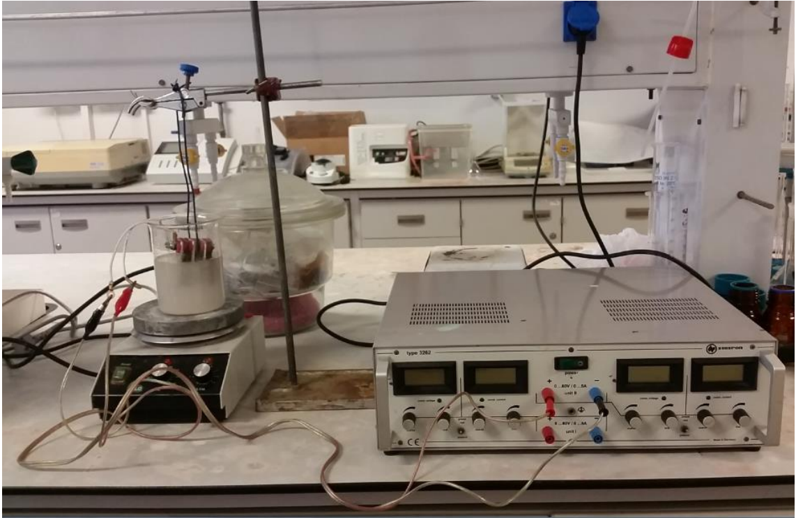
Şekil 5.16. Elektrokoagülasyon deney düzeneği
