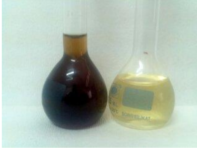
Şekil 7.1: Arıtım öncesi ve sonrası sızıntı suyu
