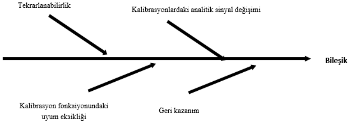
Şekil 3.9. Belirsizlik hesabında kullanılan balık kılçığı diagramı
