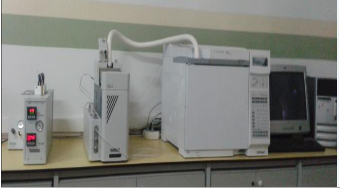
Şekil 3.6. UOB analizlerinde kullanılan TD-GK-FID sistemi
