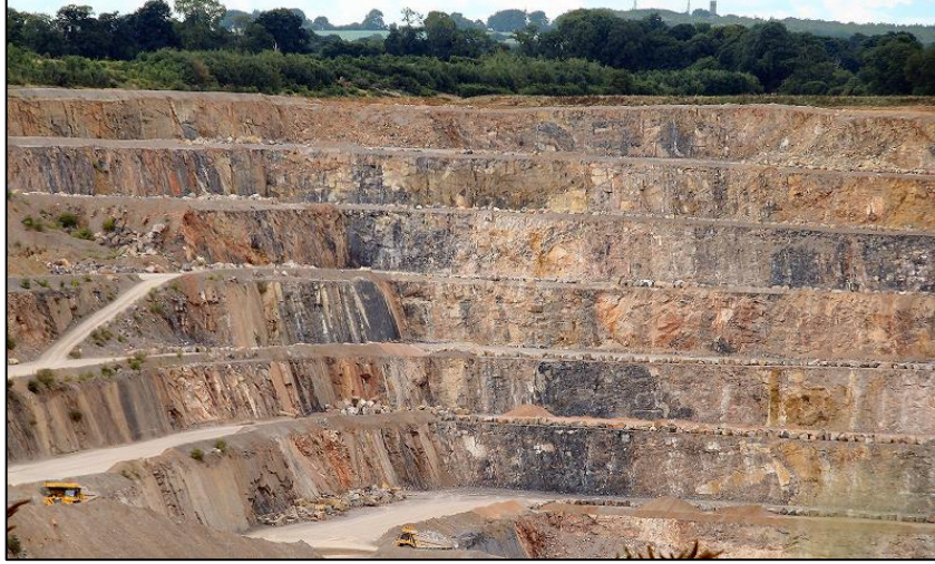
Görsel 2.1. Çimento üretiminde ana bileşen kalkerin istihraç edildiği açık ocak işletmesi
