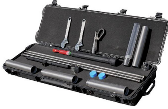
Şekil 4.4 Sediment Örneklemeye Kullanılan örnekleyici (AMS Çok aşamalı çamur ve sediment örneklemeye kiti (AMS, American Falls ID))
