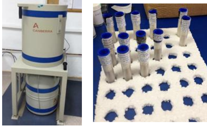
Şekil 4.13 Gama Radyoaktivite Cihazı, ölçüme hazırlanmış numuneler
