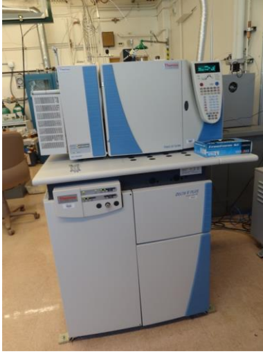
Şekil 4.16 Elementel Analiz Cihazı _İzotop Oran Kütle Spektrofotometresi (Thermo Scientific Flash Delta V™ Isotope Ratio Mass Spectrometer)
