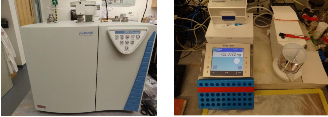
Şekil 4.15 Elemental Analiz Cihazı (Thermo Scientific Flash 2000 CHNS-O analyzer) ve mikro tartı (Mettler Toledo)
