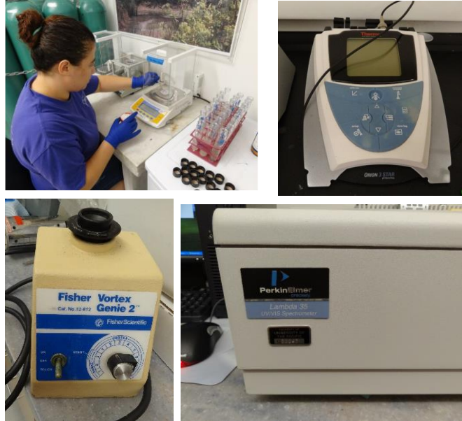
Şekil 4.18 Toplam Fosfor analizinin yapılışı ve kullanılan cihazlar
