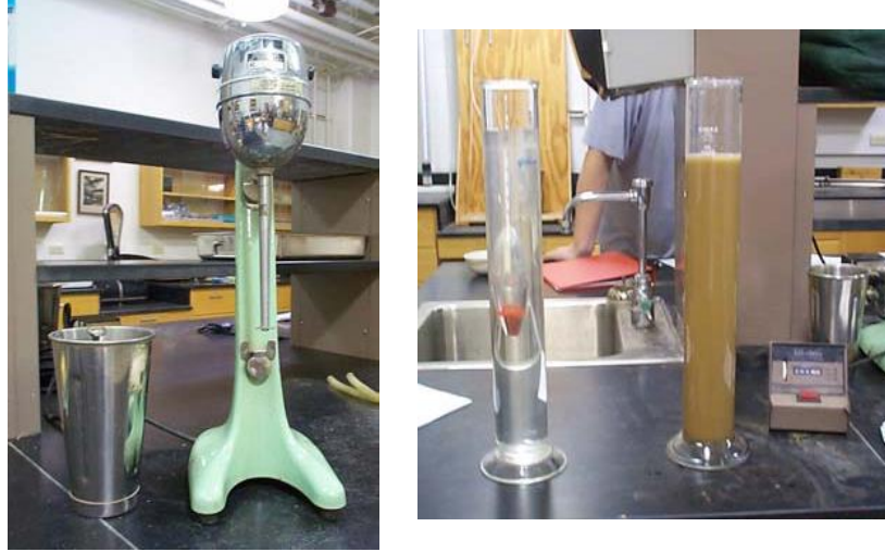
Şekil 4.12 Hidrometre analizinde kullanılan çalkalayıcı ve hidrometre mezürü
