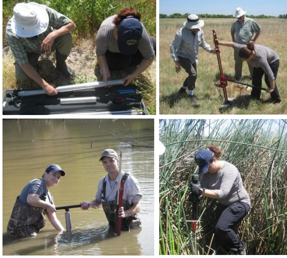
Şekil 4.4 Sediment Örneklemeye Kullanılan örnekleyici (AMS Çok aşamalı çamur ve sediment örneklemeye kiti (AMS, American Falls ID))
