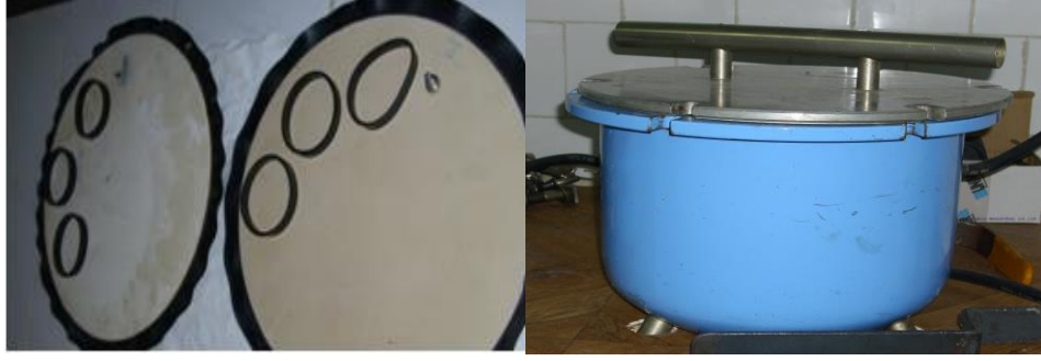
Şekil 4.2. Tarla kapasitesi tayininde kullanılan deney düzeneği
