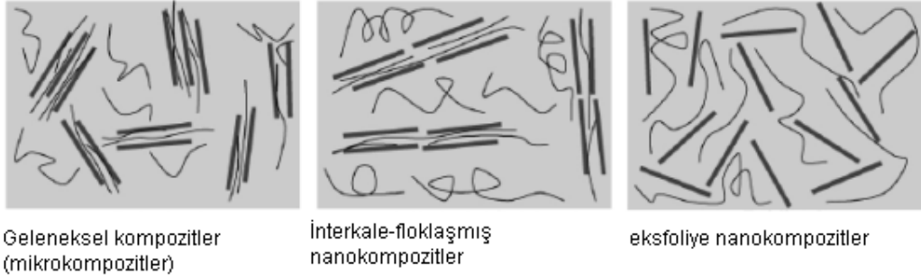
Şekil 3.11. Polimer/organik olarak modifiye edilmiş tabakalı silikat kompozitlerinin türleri
