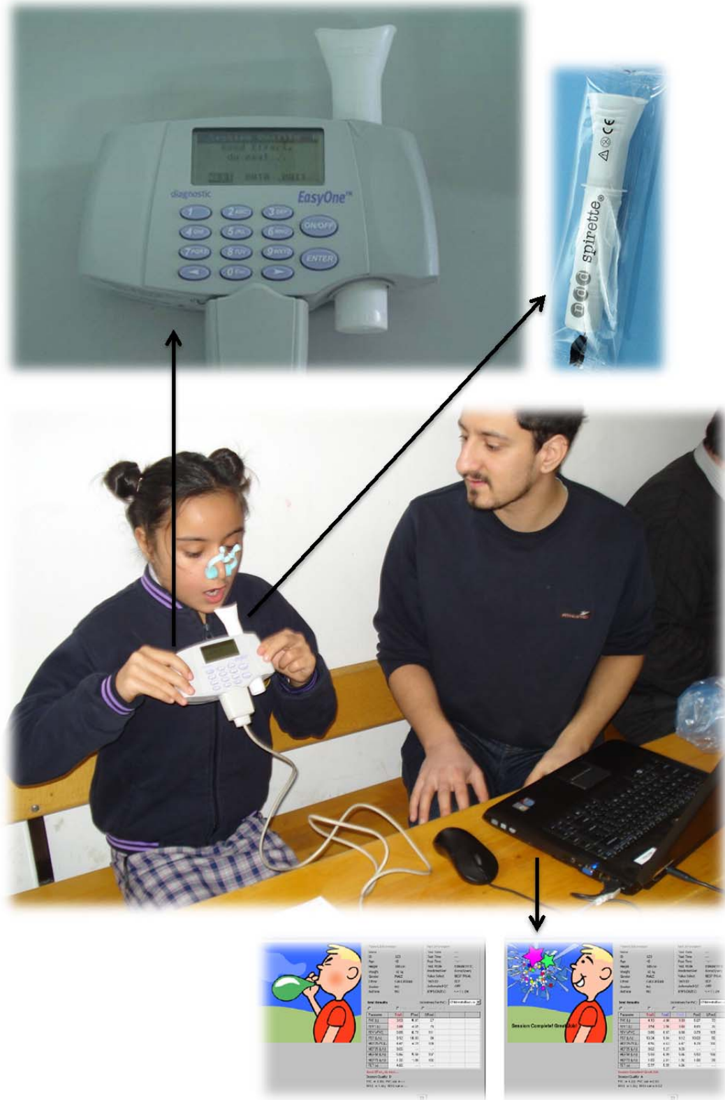
Şekil 4. 8. Solunum fonksiyon testinin uygulanması ve kullanılan düzenek (spirometre cihazı, ağızlık ve bilgisayar)
