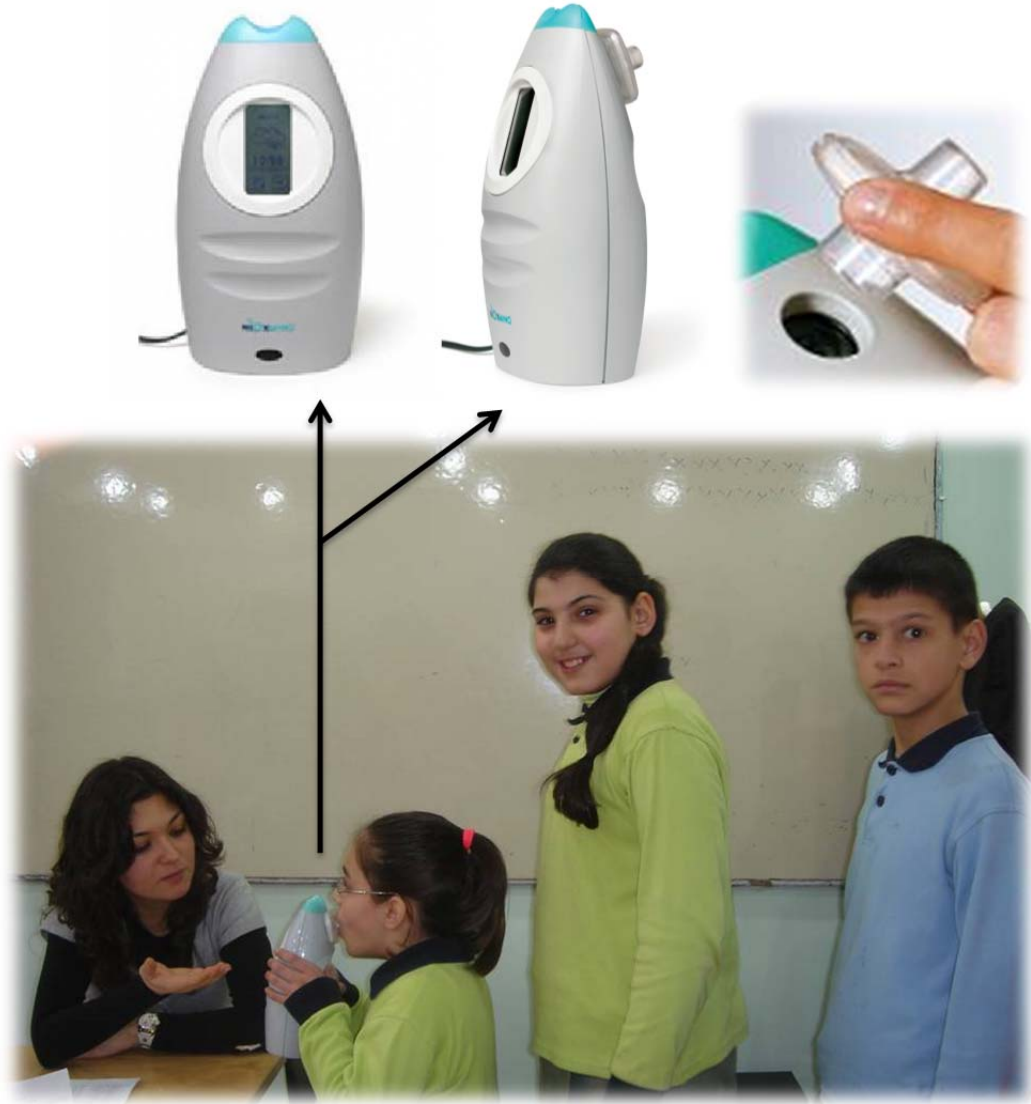
Şekil 4. 9. Ekshale NO ölçümünün uygulanması ve kullanılan analiz cihazı
